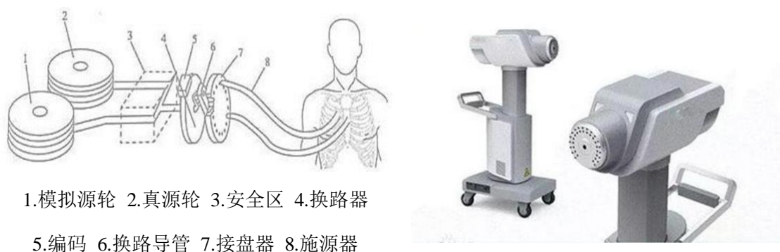
图 1-4 后装机治疗工作原理图
